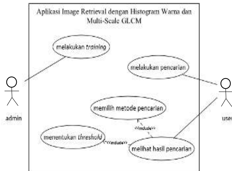
Gambar 1 Use Case Diagram Aplikasi Image Retrieval dengan Histogram Warna dan Multi-scale GLCM
