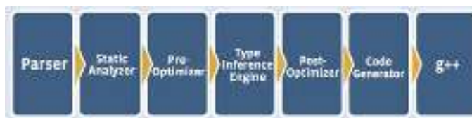
Gambar 3 Proses Transformasi PHP ke C++
