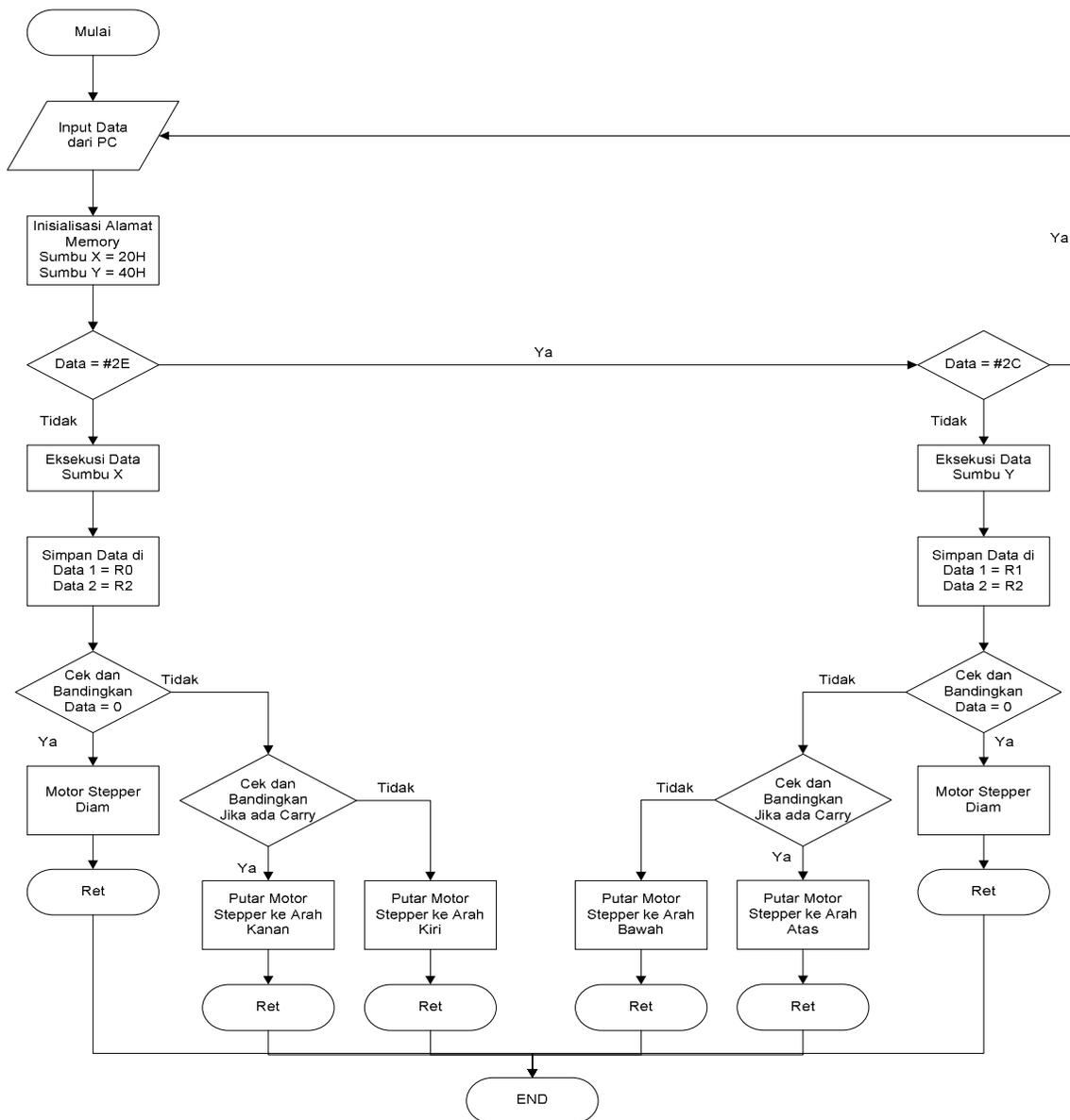
Gambar 7. Diagram Alir Software Sistem Penjejak Benda
